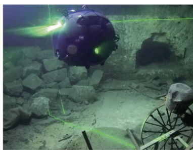
图8 球型水下机器人 UNEXMIN [66]
