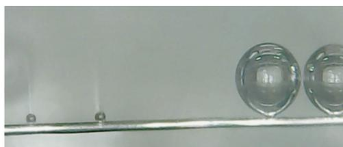
图3 加热丝上大小气泡射流现象
