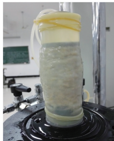
图2 三轴试验砂土试件破坏
